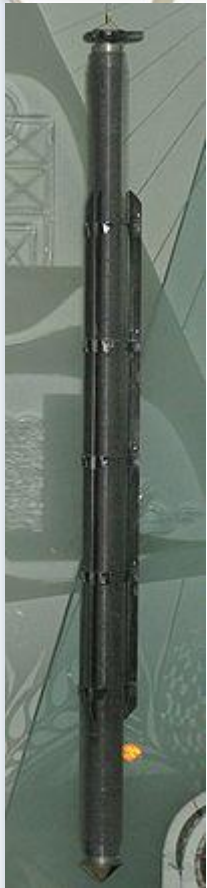
Element paliwowy typu Magnox
